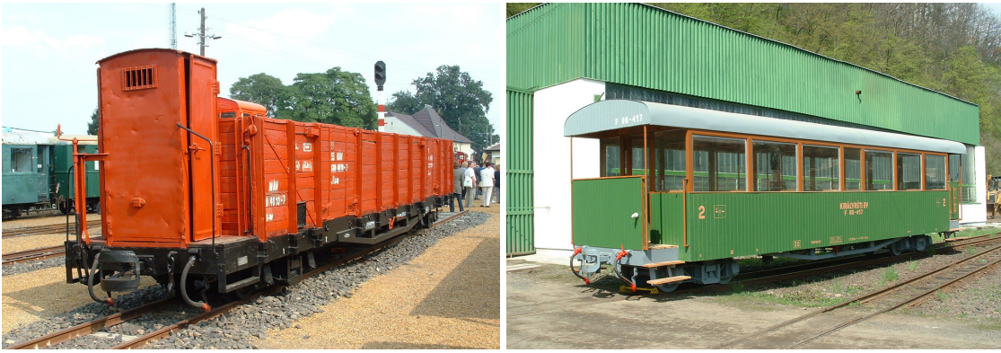
6. ábra: Jah teherkocsi (Dombrád, járműkiállítás) és alvázára a Királyréti EV műhelyében házilag épített, 77 férőhelyes személykocsi
