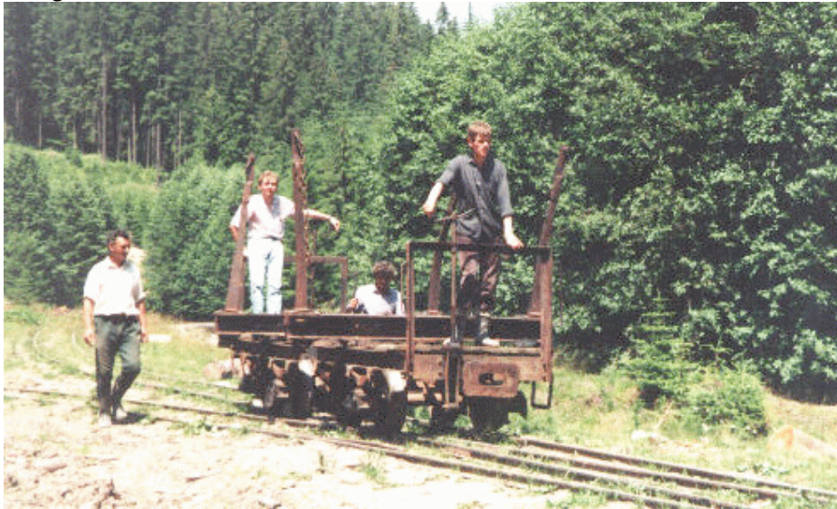
Ábra Szalasztás lejtős pályán, kézfékekkel
