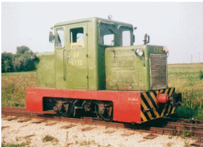
Ábra A legelterjedtebb kisvasúti mozdony: a C50-es
